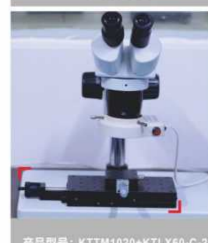
产品型号: KTTM1020+KTLX60-C-25 轴 向: XY轴 应用场 景: 显微镜工件位置的调整
